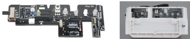
光センサ(IN1)と振動センサ(IN2)でフルカラーLED(OUT1~3)と白色高輝度LED3個
