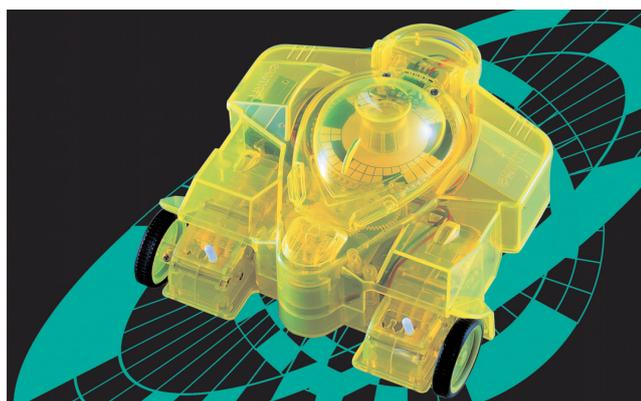
デジタルロボットはフォトセンサを使って回転するディスクの明暗を読み取り、左右のモータを回転させたり停止させたりしながら、自在に進むことができます。また、デジタルロボットは、自由にプログラムディスクを作ることができます。
